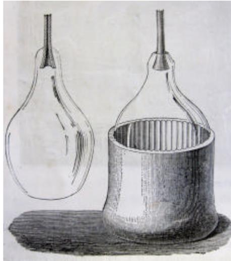
**Fig. n. 21** Forma per la realizzazione di lastre di vetro con scanalature.
