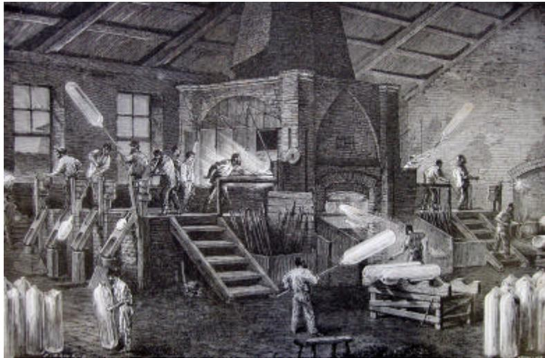
**Fig. n. 4** Illustrazione di un forno di fabbricazione di lastre di vetro di fine '800. Da notare i soppalchi eretti intorno al forno per agevolare la soffiatura dei cilindri.
