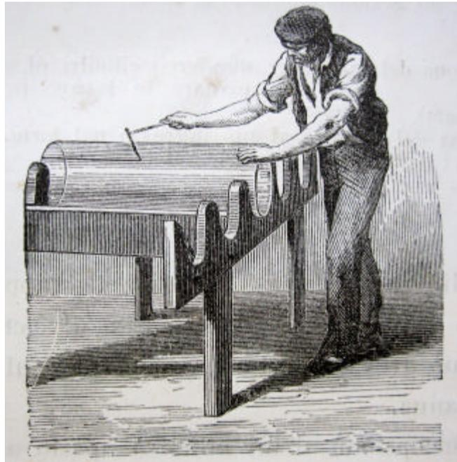
**Fig. n. 12** Uno spaccalastre durante la fase di incisione del cilindro.
